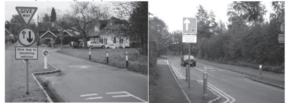
Рисунок 2. Примеры сужения проезжей части
