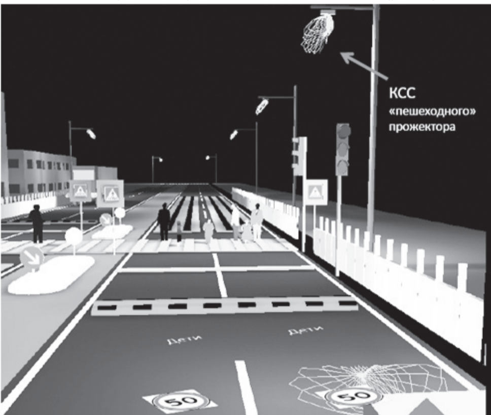
Рисунок 29. Пример правильно освещенного пешеходного перехода. Стоп-линия. Лежащий полицейский. Предупреждающая надпись
