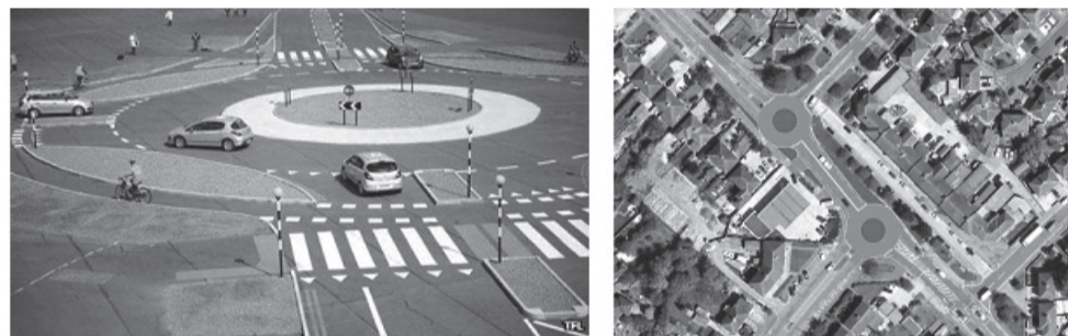
Рисунок 8. Примеры канализированного движения на перекрестках
